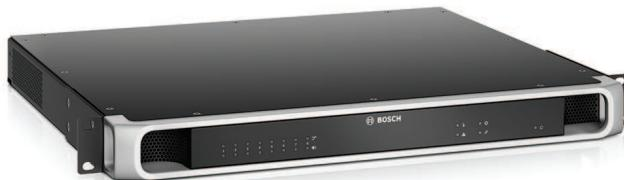
Toto je flexibilní a kompaktní vícekanálový výkonový zesilovač pro 100V nebo 70V reproduktordové systémy v aplikacích veřejného ozvučení a evakuačního rozhlasu. Tento výkonový zesilovač pasuje do topologií centralizovaného systému, ale podporuje také topologie decentralizovaného systému, a to díky připojení k síti protokolem IP OMNEO, které je kombinováno se stejnosměrným (DC) napájením z multifunkčního napájecího zdroje.
